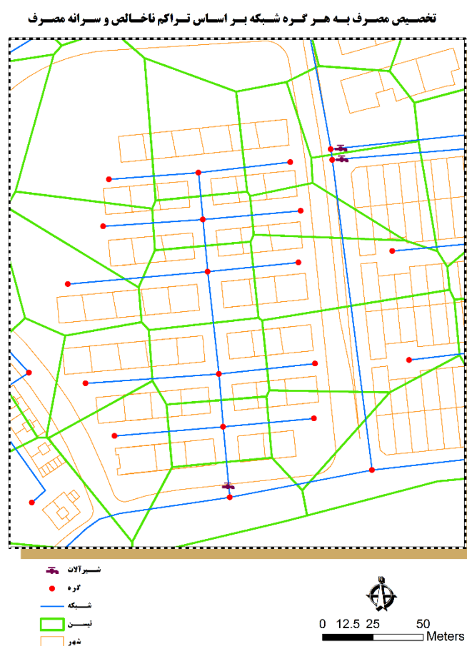
شکل شماره ۲: اختصاص بار به هر گره شبکه توزیع بر اساس روش تیسن بندی
